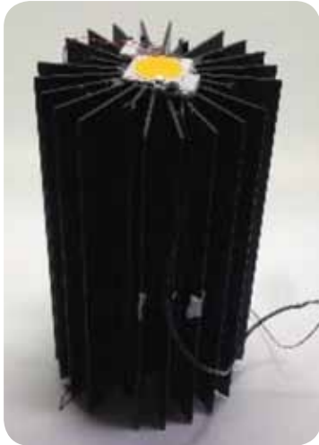
图7: 安装在Wakefield散热片上的CXA3050 LED集成阵列
